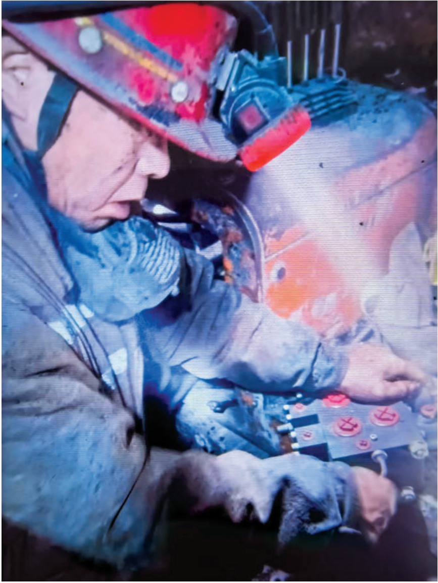
王振杰在对综掘机的油路进行改造。
