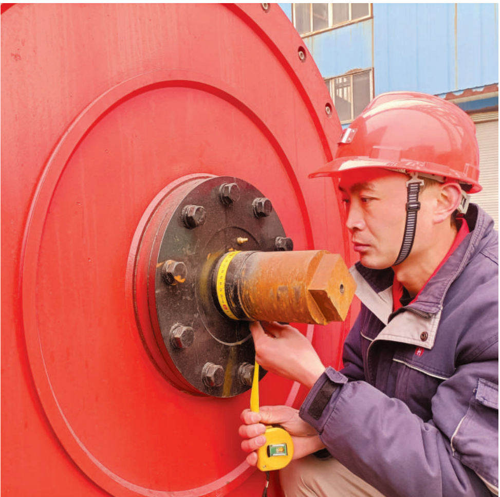
赵醒在校准造机筒体传动轴尺寸。
