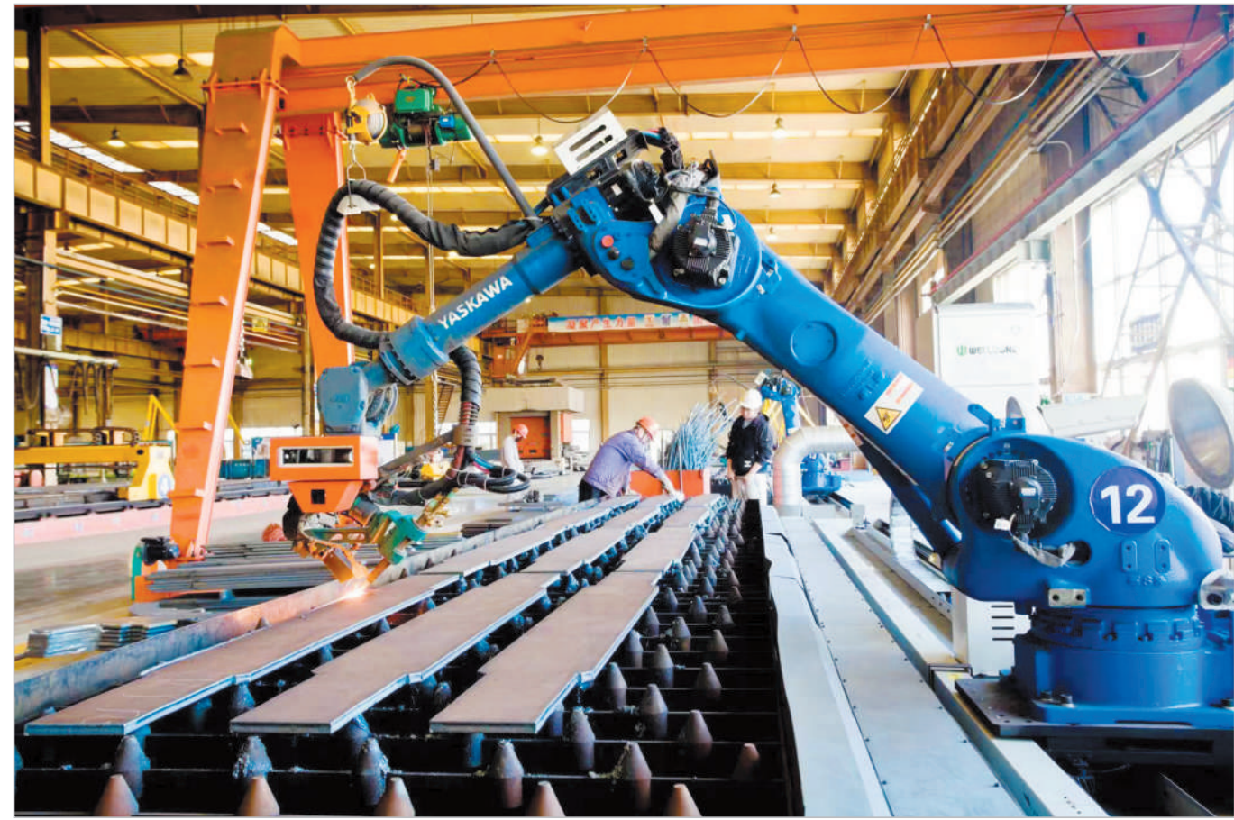
安徽矿机智能坡口机器人正在进行坡口加工处理。
