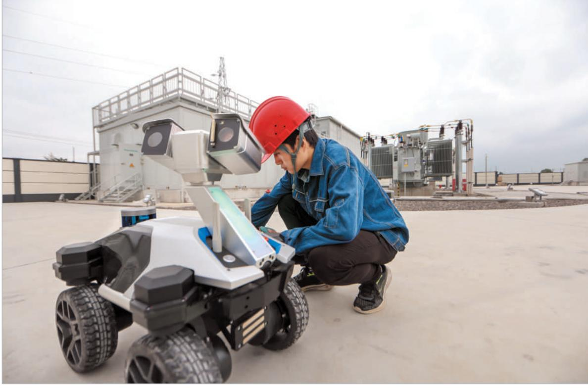
7月25日,在濉溪县35千伏“5G+源网荷储”谭家变电站,供电人员正在使用5G通讯、智能巡检机器人对站内设备进行巡视。
