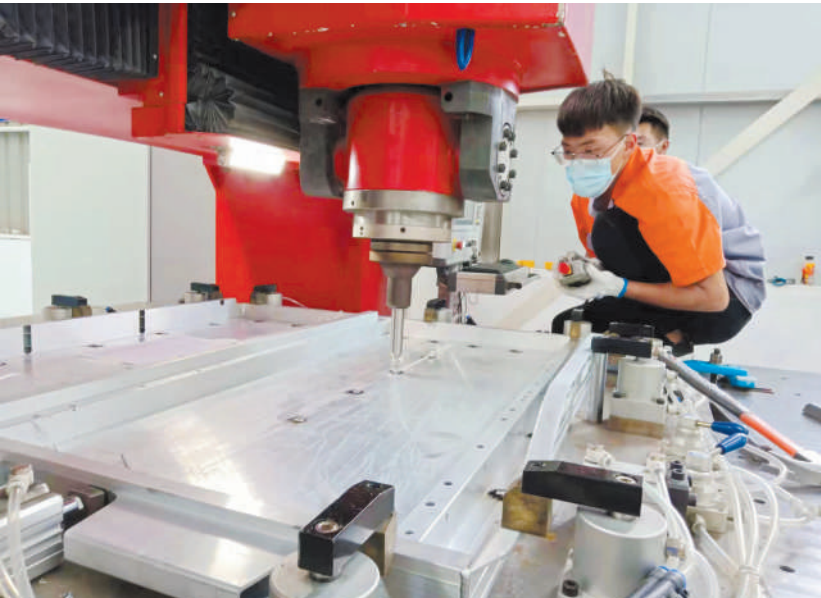
国轩象铝使用赛福斯特先进的搅拌摩擦焊接技术实现无缝焊接。
