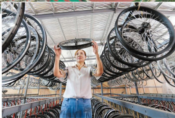
金鑫电动车生产车间内,工人在检查车轮。
