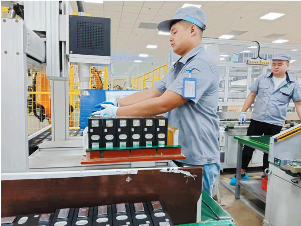
明美新能源员工在锂电池模组全自动化柔性生产线上整理待测电芯。
