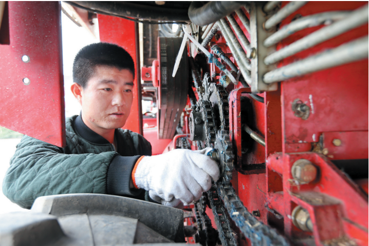
濉溪县路达农机合作社技术员检修联合收割机。
