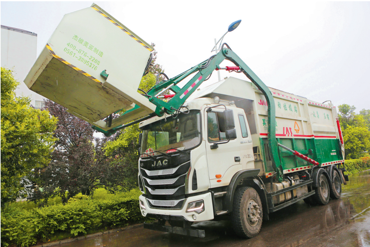
自装卸式垃圾压缩车演示垃圾收集过程。 ■ 摄影 记者 黄鹤鸣
