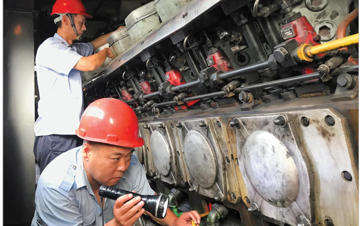
7月16日,铁运处烈山机辆段运转车间乘务员在检查机车“心脏”部位柴油机,确保机车运行安全。
