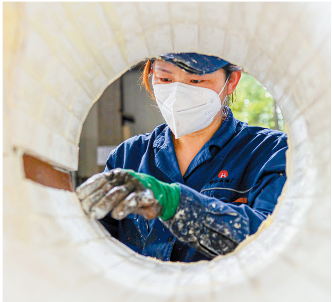
新宇公司工人在为矿机贴耐高温陶瓷片。
