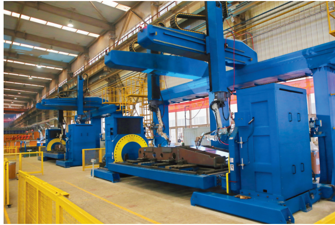
安徽矿机引进的机器人正在进行自动焊接工作。
